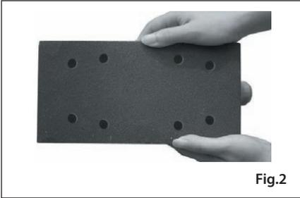
Levante os cliques da base e abra-os de maneira a inserir uma extremidade da folha de lixa.
