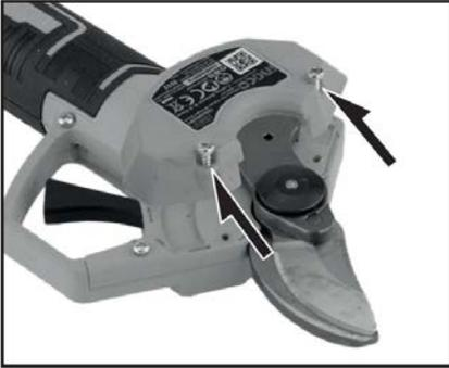
**2.1.** Desaperte os parafusos e remova a capa lateral.
