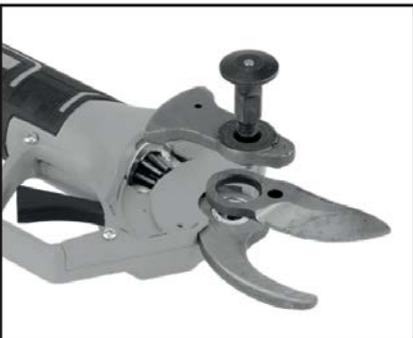
**2.3.** Retire a lâmina de movimento, remova a lâmina antiga e substitua com uma nova.
